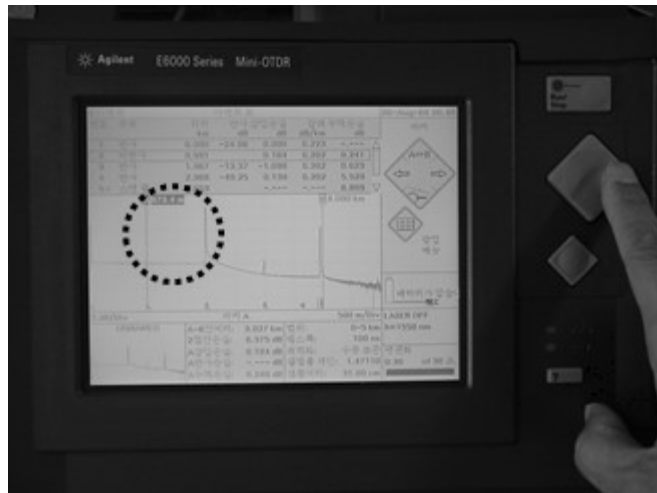
[그림 5-21] OTDR 사용법(VII) 이벤트 발생지점으로 마커 이동
