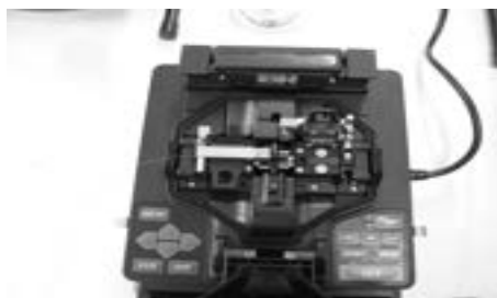
[그림 4-14] 클램프 및 광섬유홀더, 방풍 덮개를 닫음
