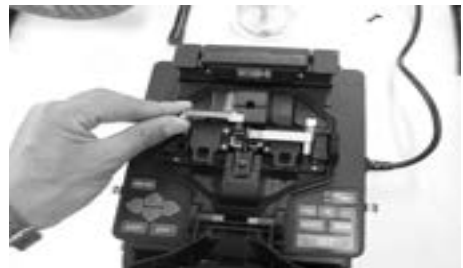
[그림 4-12] 접속기(OTDR)의 방풍 덮개와 클램프, 광섬유홀더 오픈
