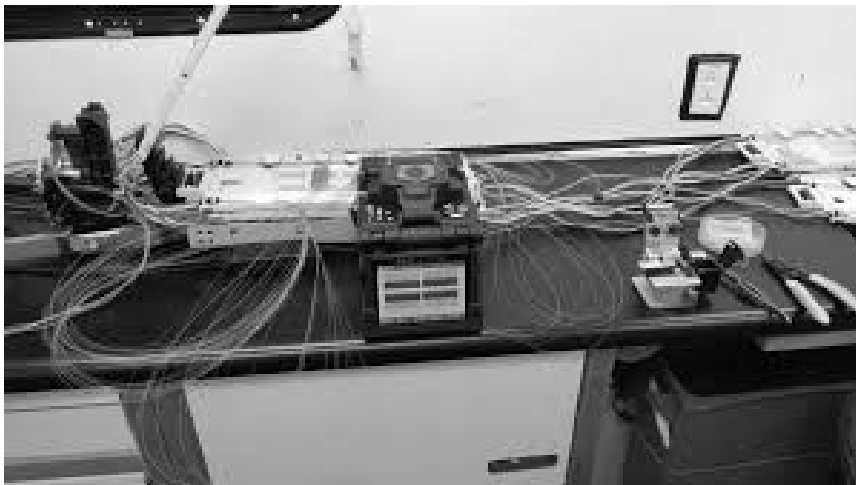
[그림 4-2] 광케이블 심선 접속 환경 준비(예시)
