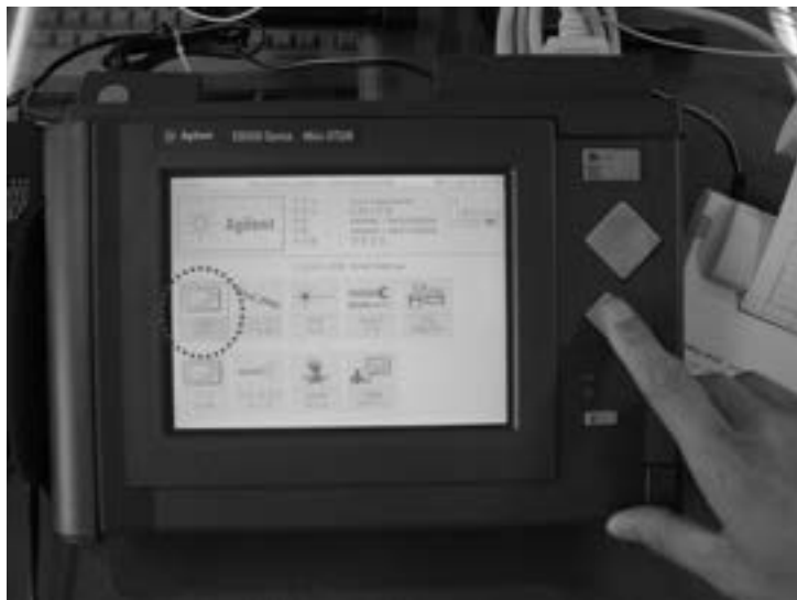
[그림 5-16] OTDR 사용법(Ⅱ) OTDR 모드 선택
