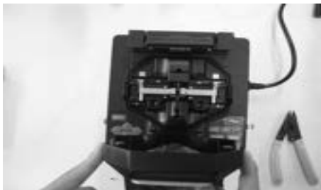
[그림 4-12] 접속기(OTDR)의 방풍 덮개와 클램프, 광섬유홀더 오픈
