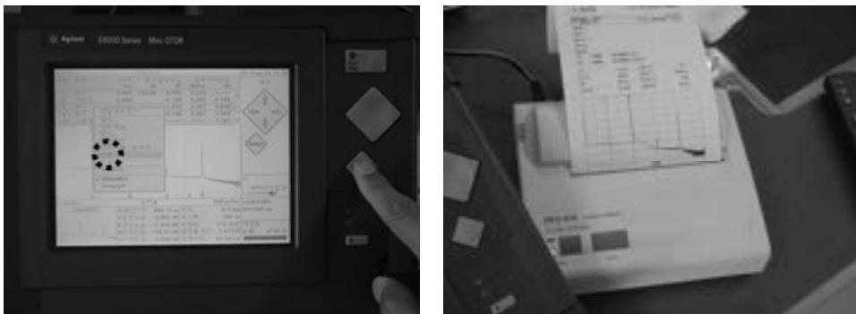
[그림 5-24] OTDR 사용법(X) 결과값 프린트
