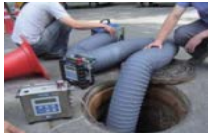
[그림 2-8] 산소 및 유해가스 농도 측정기 및 환기장치
