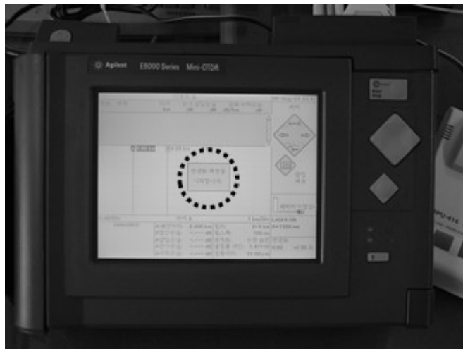
[그림 5-20] OTDR 사용법(VI) 평균화 측정시작
