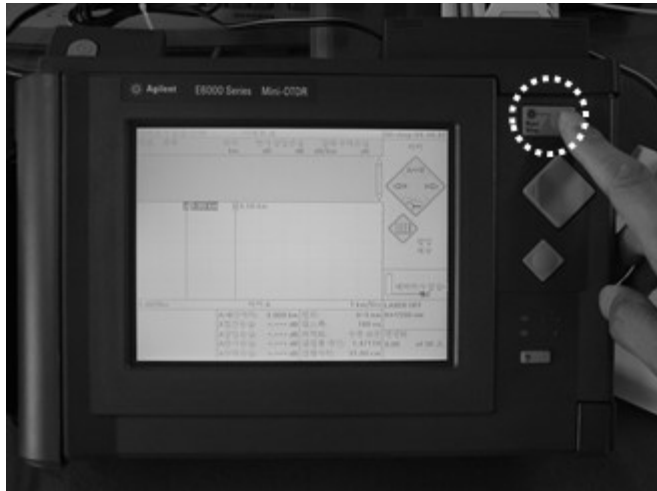
[그림 5-19] OTDR 사용법(V) Run/Stop 버튼을 누름
