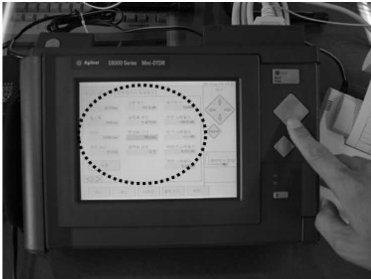
[그림 5-18] OTDR 사용법(Ⅳ) 측정조건 설정
