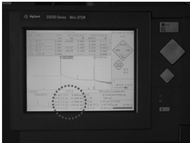
[그림 5-22] OTDR 사용법(VIII) 거리, 손실 등 확인
