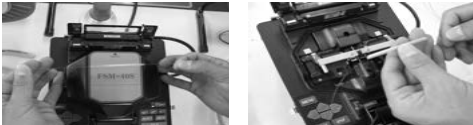
[그림 4-21] 열수축 슬리브 가열 완료 및 보강상태 확인
