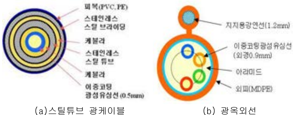
[그림 1-9] 스틸튜브 광케이블 및 광옥외선의 구조
