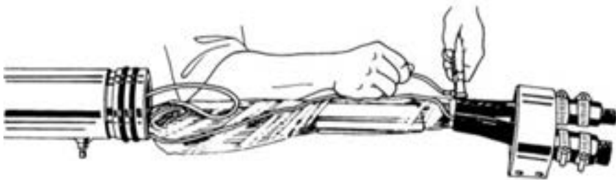
[그림 3-9] 본드선 부착(예시)
