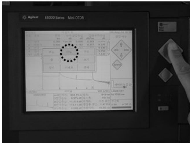
[그림 5-23] OTDR 사용법(IX) 메뉴에서 파일 선택
